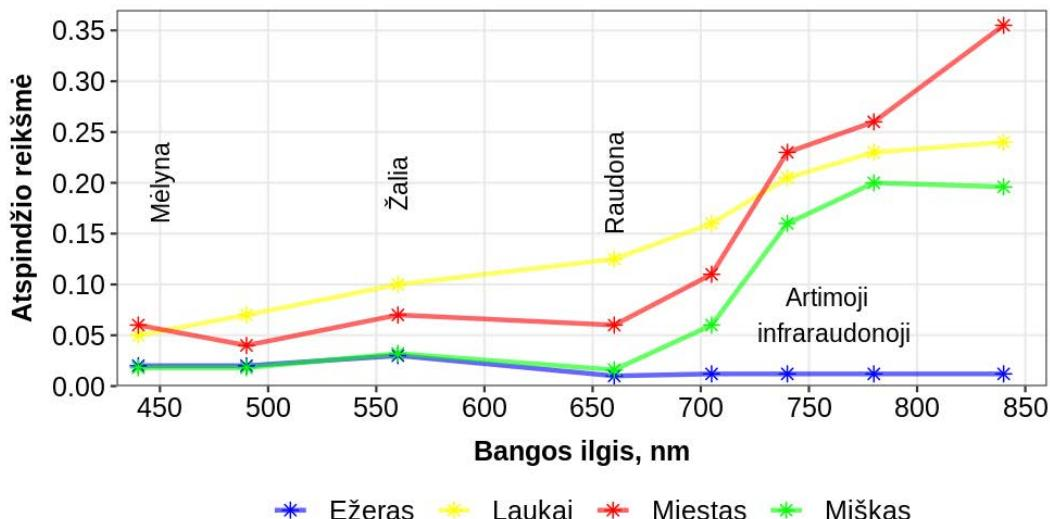
**1.2.9. pav.** Žemės paviršiaus objektų elektromagnetinių bangų atspindėjimo charakteristikos įvairiose elektromagnetinių bangų spekto zonose.
