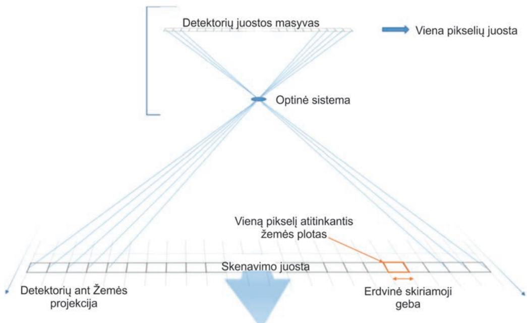
**2.1.5. pav.** Pasyviųjų skenuojamujų jutiklių (skenavimo išilgai kelio) vaizdų generavimo schema.
