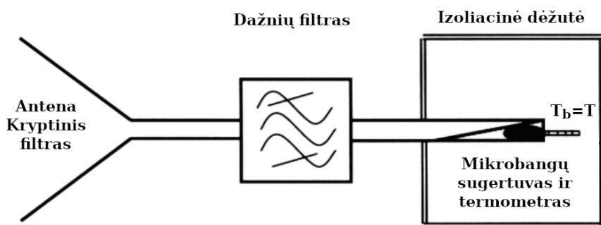
**2.4.3. pav.** Mikrobangų radiometro konstrukcijos schema. Signalas yra priimamas antena su kryptiniu filtru, iš ten yra perduodamas į dažnių filtrą, kur signalas sustiprinamas, ir galiausiai patenka į detektorių, kuris surinktą mikrobangų spinduliuotę paverčia į temperatūrą  $T$ . Išmatuota temperatūra  $T$  yra prilyginama ryškio temperatūrai  $T_b$  (pagal Marzano, Visconti, 2002).
