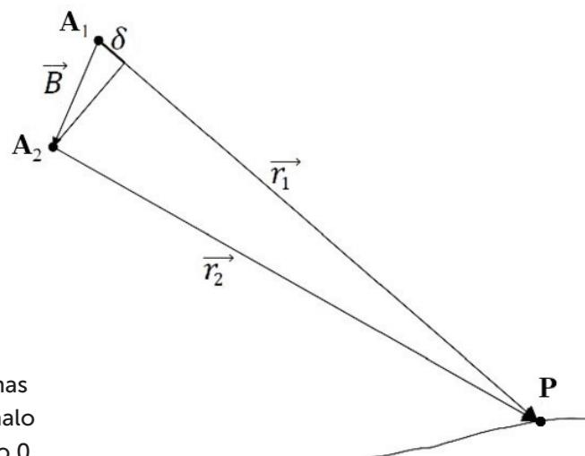
**2.5.13. pav.** Radar interferometrijos geometrinė schema. Nuo Žemės paviršiaus taško  $P$  į palydovus  $A_1$  ir  $A_2$  grīžtantis radaro signalas keliauja skirtingu atstumu tarp  $r_1$  ir  $r_2$ . Skirtumas tarp  $r_1$  ir  $r_2$  ( $\delta$ ) lemia sugrīžtančio signalo fazės skirtumą, kuris gali svyruoti nuo 0 iki  $2\pi$  radianų.
