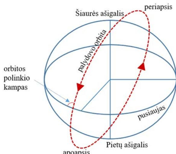
1.3.3. pav. Dirbtinių Žemės palydovų orbitos plokštumos ir orbitos polinkio kampus.
