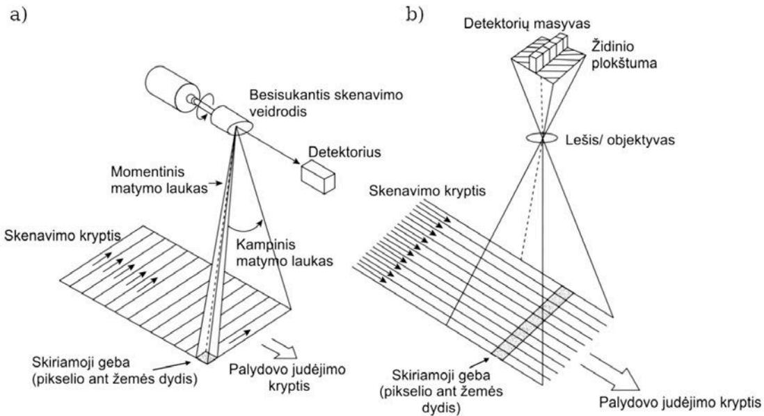
**2.2.9. pav.** Palydovų jutiklių paviršiaus skenavimo būdai: a) skersai ir b) išilgai palydovų skriekimo trajektorijos (pagal Kang, Pan ir kt., 2017).
