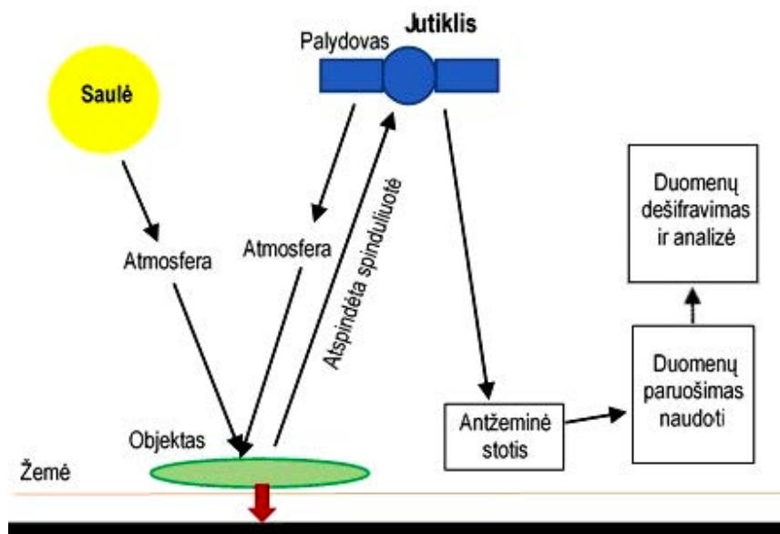
Taikant nuotolinius Žemės paviršiaus tyrimus pirmiausia reikalingas energijos šaltinis. Jis turi apšvesti tiriamą teritoriją (objektą). Kitas galimas atvejis – kai registruojamą energiją skleidžia pats objektas. Tokia energija yra vadinama elektromagnetine spinduliuote. Tipiškas elektromagnetinės spinduliuotės pavyzdys yra Saulės šviesa.
