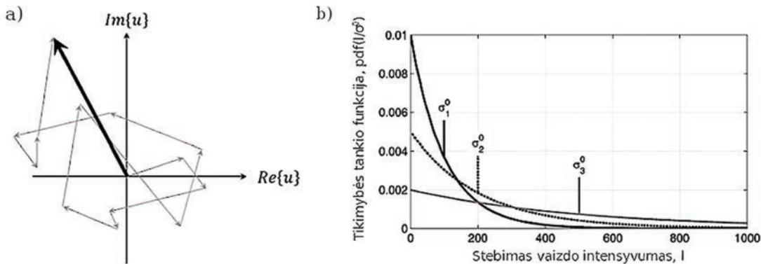
**2.5.6. pav.** SAR vaizdo grūdėtumo prigimtis: a) atgalinis signalas yra koherentinė atskirų išskaidymo atvejų suma stebimo pikselio viduje; b) vaizdų su skirtingais atgalinės sklaidos koeficientais  $\sigma^0$  grūdėtumo tikimybės tankio funkcija (pdf) (pagal Flores ir kt., 2019).
