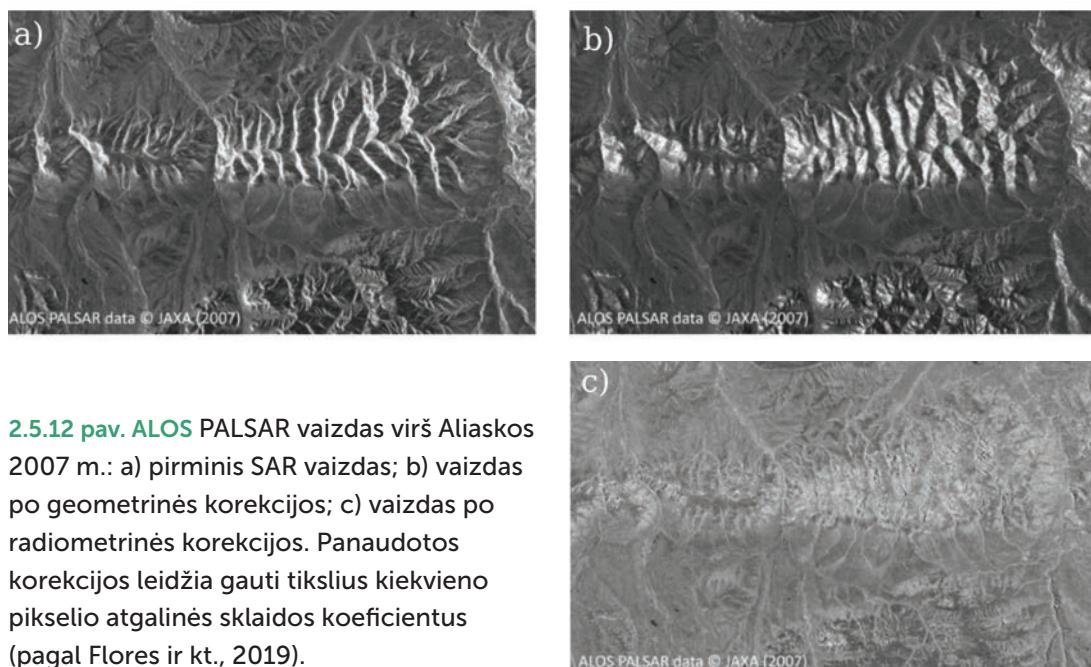
**2.5.12 pav. ALOS PALSAR** vaizdas virš Aliaskos 2007 m.: a) pirminis SAR vaizdas; b) vaizdas po geometrinės korekcijos; c) vaizdas po radiometrinės korekcijos. Panaudotos korekcijos leidžia gauti tikslius kiekvieno pikselio atgalinės sklaidos koeficientus (pagal Flores ir kt., 2019).
