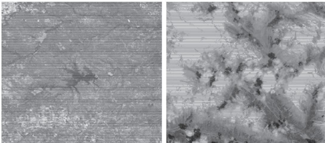
2.6.6. pav. Juostuotumas palydovo *Landsat* vaizduose (USGS, 2020a).
