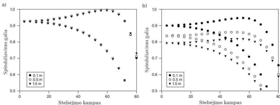
**3.6.2. pav.** Modeliuojant gauta spinduliaivimo geba pasirinkus skirtinges stebėjimo kampus ir skirtinges sniego storj (0,1; 0,5; 1,5 m): a) 10 GHz; b) 37 GHz. Modeliuojant laikyta, kad sniego ir paklotinio paviršiaus temperatūra buvo 271 K, sniego dalelių skersmuo 0,5 mm, o sniego tankis 0,3 g/cm<sup>3</sup>. Juodi simboliai rodo vertikalią polarizaciją, o balti – horizontalią (pagal Tedesco, 2003).
