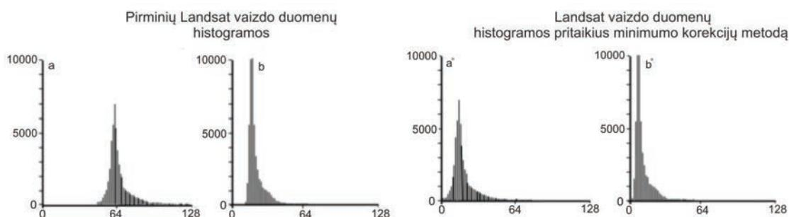
**2.6.10. pav. Histogramų minimumo metodo taikymas** Landsat vaizdo pikselių radiometrinei korekcijai ir vaizdų normalizavimui. *a* ir *b* – histogramas prieš korekciją; *a'* ir *b'* – po korekcijos.
