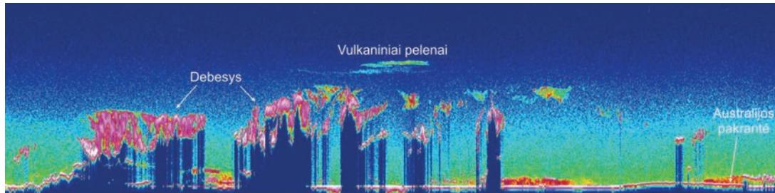
**2.3.6. pav.** Palydovo CALIPSO lidaro CALIOP užfiksuotas skersinis atmosferos pjūvis virš Pietryčių Azijos, Indonezijos ir Australijos teritorijų 2006 m. birželio 7 d. Žalsvi, gelsvi ir melsvi atspalviai paveiksle rodo jutiklio lazerio signalo atspindžio nuo debesų, aerozolių ir oro molekulių intensyvumą. Debesys pavaizduoti šviesiais rožinės ir baltos spalvos atspalviais, po debesimis matomos tamsios zonas, kur signalas neprasiskverbia iki Žemės paviršiaus (pagal Lorentz, 2011).
