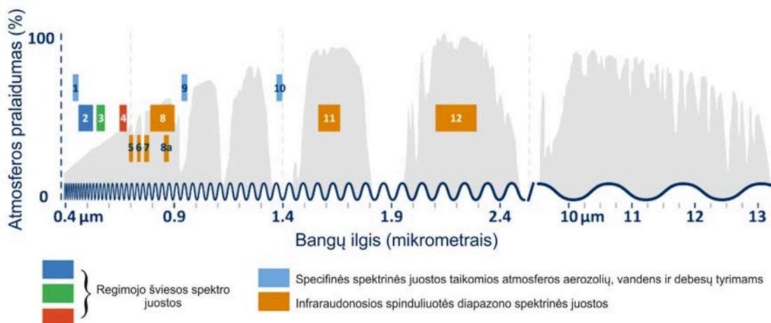
**2.3.10. pav.** Palydovo *Sentinel 2* palydovo kanalu ir jų spektrinių spektro ruožų juostų išsidėstymas elektromagnetinės spinduliuotės spektre.
