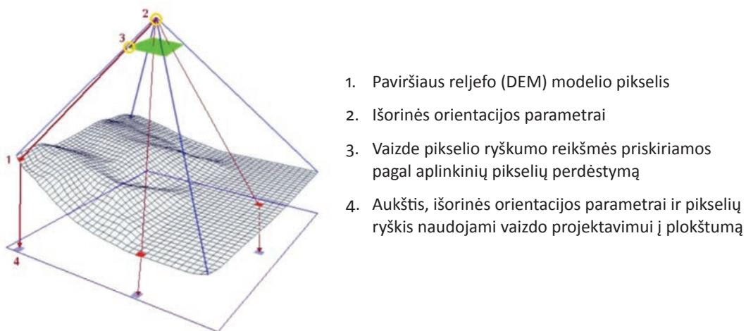
**2.6.2. pav.** Palydovinių vaizdų ortorektifikacija, kurios metu pašalinami paviršiaus reljefo nulemti geometriniai vaizdų iškraipymai (pagal Leica Geosystems, 2005).
