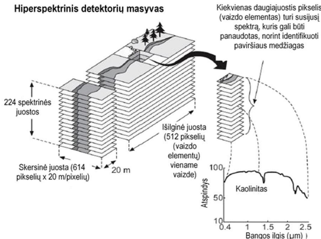
**2.2.12. pav.** Detektorių konfigūracija hiperspektrinių vaizdų gavimo sistemoje.
