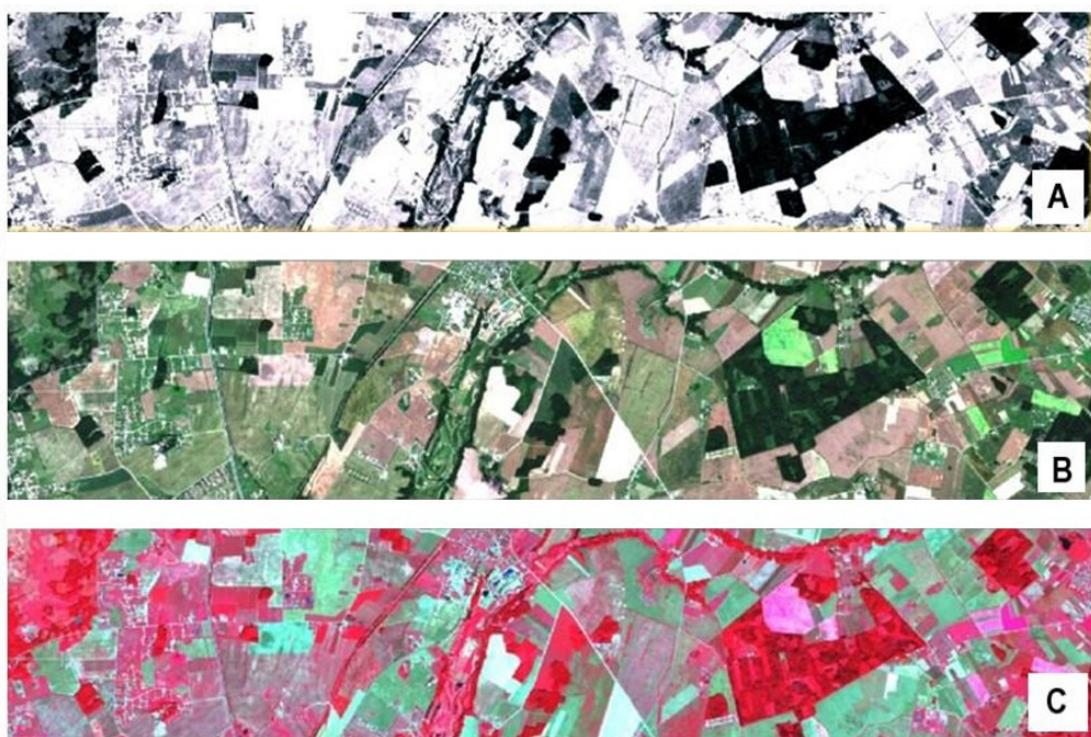
**2.2.11. pav.** Panchromatiniu (A), natūraliu (B) ir netikru (C) spalvų deriniai naudojant palydovo *Sentinel 2* vaizdą, gautą 2019 m. liepos 20 d.
