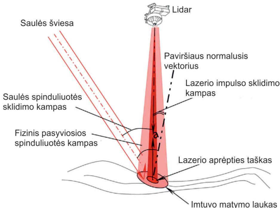
**2.3.1. pav.** Palydovinių lidarų Žemės paviršiaus skenavimo schema, signalo sklidimo savybės ir ji veikiantys veiksnių bei rodikliai. Lidarai generuoja, spinduliuoja ir regisruioją atmosferoje ir nuo paviršių atspindėtą spinduliuotę jų generuojamų elektromagnetinių bangų diapazone, taikinio savybės identifikuojamos per gržtamojo ir spinduliuojamo signalo pokytį (pagal Sun, 2018).
