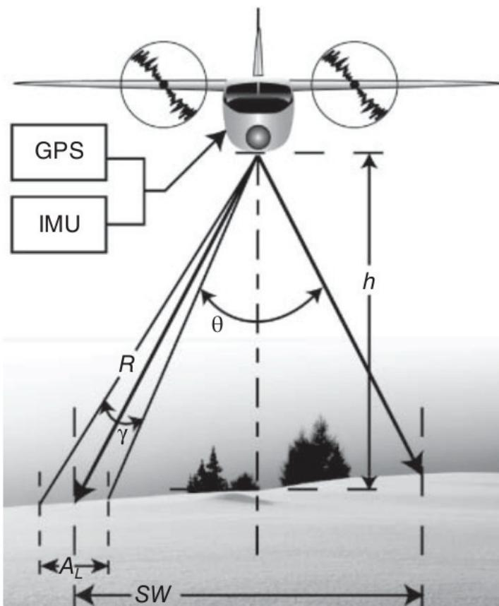
**3.6.4. pav.** Lidaro veikimo geometrija. GPS – globali padėties nustatymo sistema; IMU – jutiklio orientacijos nustatymo sistema;  $R$  – matavimo nuotolis,  $\theta$  – skenavimo kampus,  $h$  – orlaivio ar palydovo aukštis virš Žemės paviršiaus,  $\gamma$  – lidaro signalo divergencija,  $A_L$  – signalo skersmuo ant stebimo paviršiaus, o  $SW$  – žvalgos juostos plotis (Deems ir kt., 2013).
