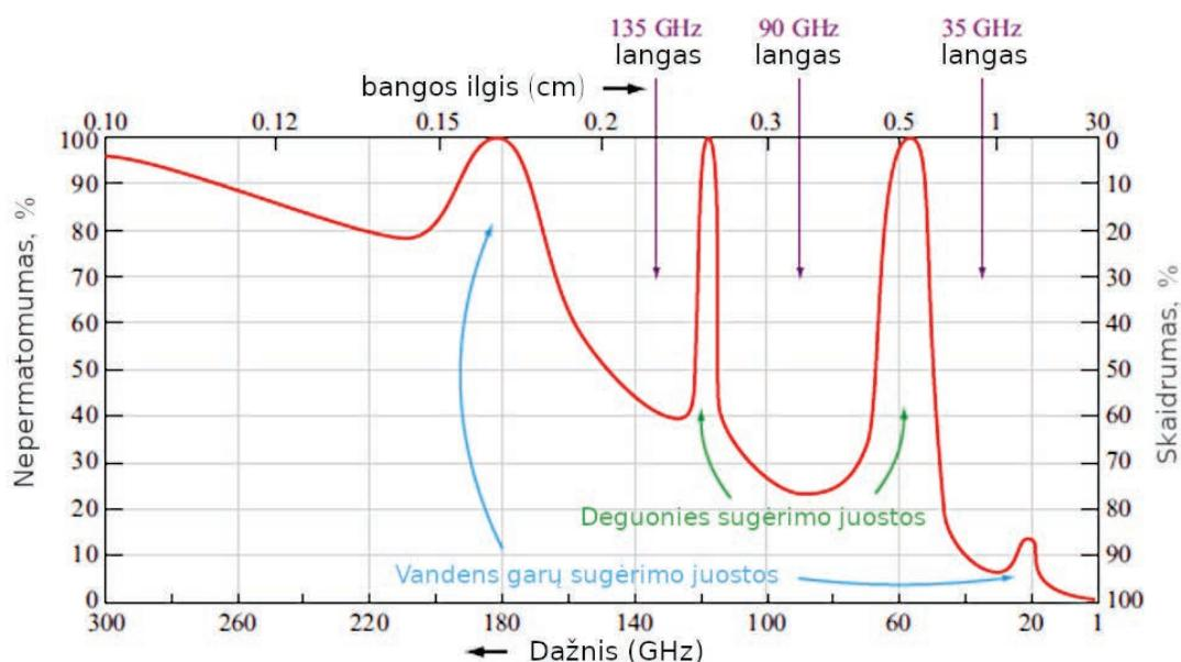
**2.4.2. pav.** Atmosferos skaidrumo langai ir vandens garų bei deguonies sugėrimo zonas mikrobangų spektre. Ties 135 GHz, 90 GHz ir 35 GHz dažnio bangomis atmosfera yra skaidri, žaliomis ir mėlynomis rodyklėmis atitinkamai pažymėti regionai, kur didžiajų mikrobangų dalį sugeria deguonis ir vandens garai (pagal Ulaby ir kt., 2013).
