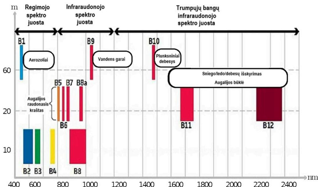
**2.2.21. pav.** *Sentinel 2* MSI (daugiaspektrio vaizdo gavimo instrumento) spektriniai kanalai (kanalų paaškinimai – 2.2.22. pav.) (pagal Kramer ir kt., 2020).
