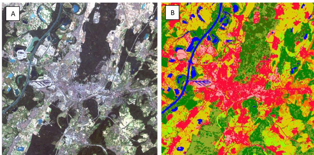
**3.1.3. pav.** Kontroliuojamomojo klasifikavimo rezultatas. Naudojant daugiaspektrį palydovinių vaizdą (paveikslėlis A) ir pritaikius kontroliuojamomojo klasifikavimo metodą gaunamos gana tiksliai išskirtos žemės dangos klasės (paveikslėlis B) (SEOS project, 2013).
