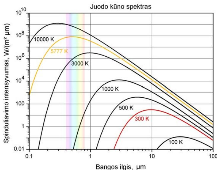
Iš palydovų stebint Žemę vandens temperatūra nustatoma naudojant pasyviųjų infraraudonųjų spindulių (IR) arba mikrobangų radiometrų duomenis. Pagrindinis skirtumas tarp šių vandens paviršiaus temperatūros vertinimo metodų yra tas, kad naudojamos skirtingesios elektromagnetinių bangų spekto dalys. Abu metodai turi privalumų ir trūkumų (3.5.2. lentelė).
