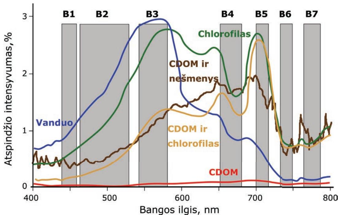
**3.5.17. pav.** Vandens spalvą lemiančių komponentų poveikis atspindžiui skirtinguose spekto dalyse ir *Sentinel 2* MSI jutiklio kanalų padėtis bei jų plotis. Prietaisas išmatuoja bendrą visų vandens spalvą lemiančių komponentų atspindį, užfiksuotą visame kanalo plotyje (pagal University of Minnesota, 2019).
