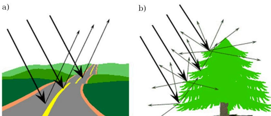
**1.2.7. pav.** Spinduliuotės atspindžio tipai nuo paviršiaus: a) veidrodinis atspindys, b) sklaidusis atspindys (pagal Canada Centre for Remote Sensing, 2009).
