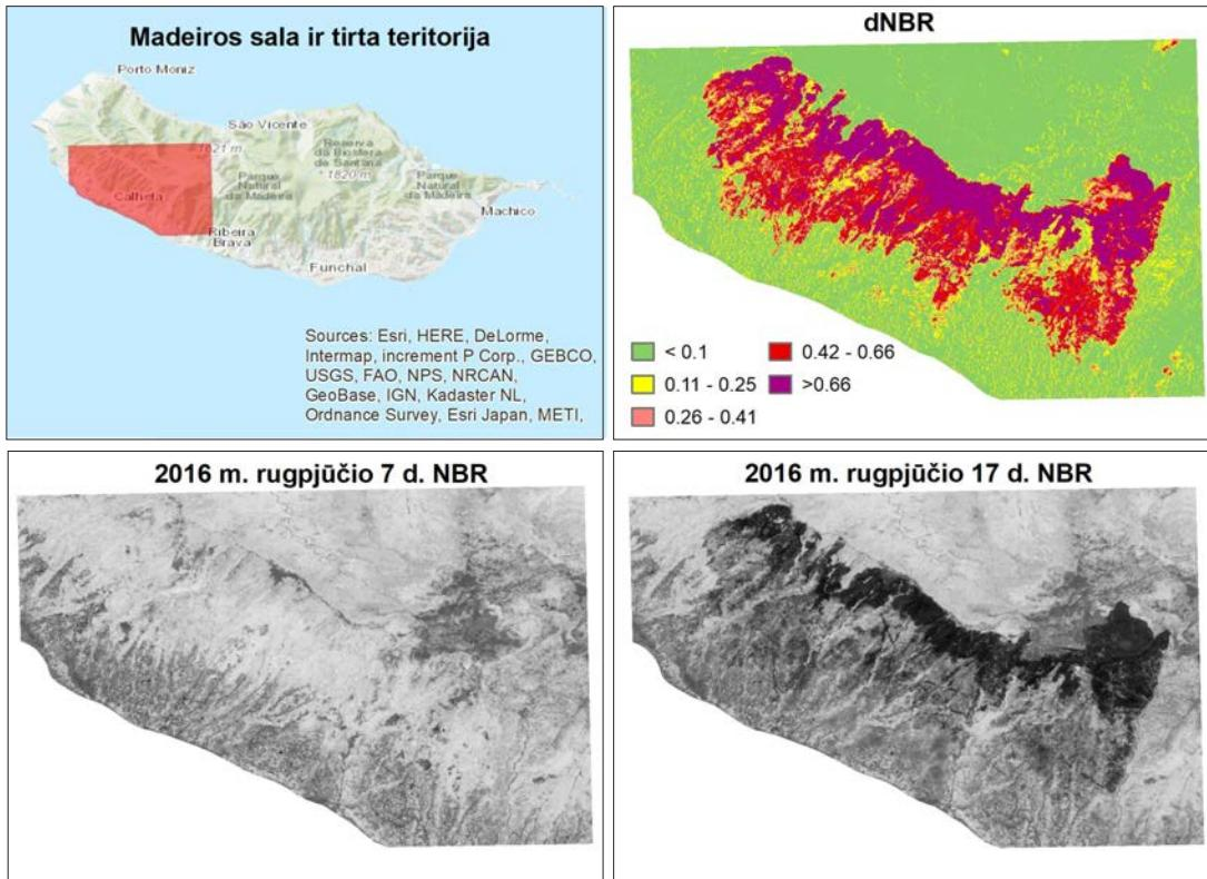
**3.4.17. pav.** NBR reikšmės prieš 2016 m. rugpjūčio mėnesio gaisrą pietvakarinėje Madeiros salos dalyje (7 d.) ir po gaisro (17 d.). Gaisro paveikti plotai pavaizduoti juoda spalva. Kuo tamsesnė spalva, tuo labiau pažeista augalija. NBR verčių prieš ir po skirtumo dNBR žemėlapyje aiškiai išskiria gaisrų paveikta teritorija. Poveikio reikšmių interpretacija pateikta 3.4.2. lentelėje. NBR indeksas apskaičiuotas pagal *Sentinel 2* palydovo MSI jutiklio duomenis.
