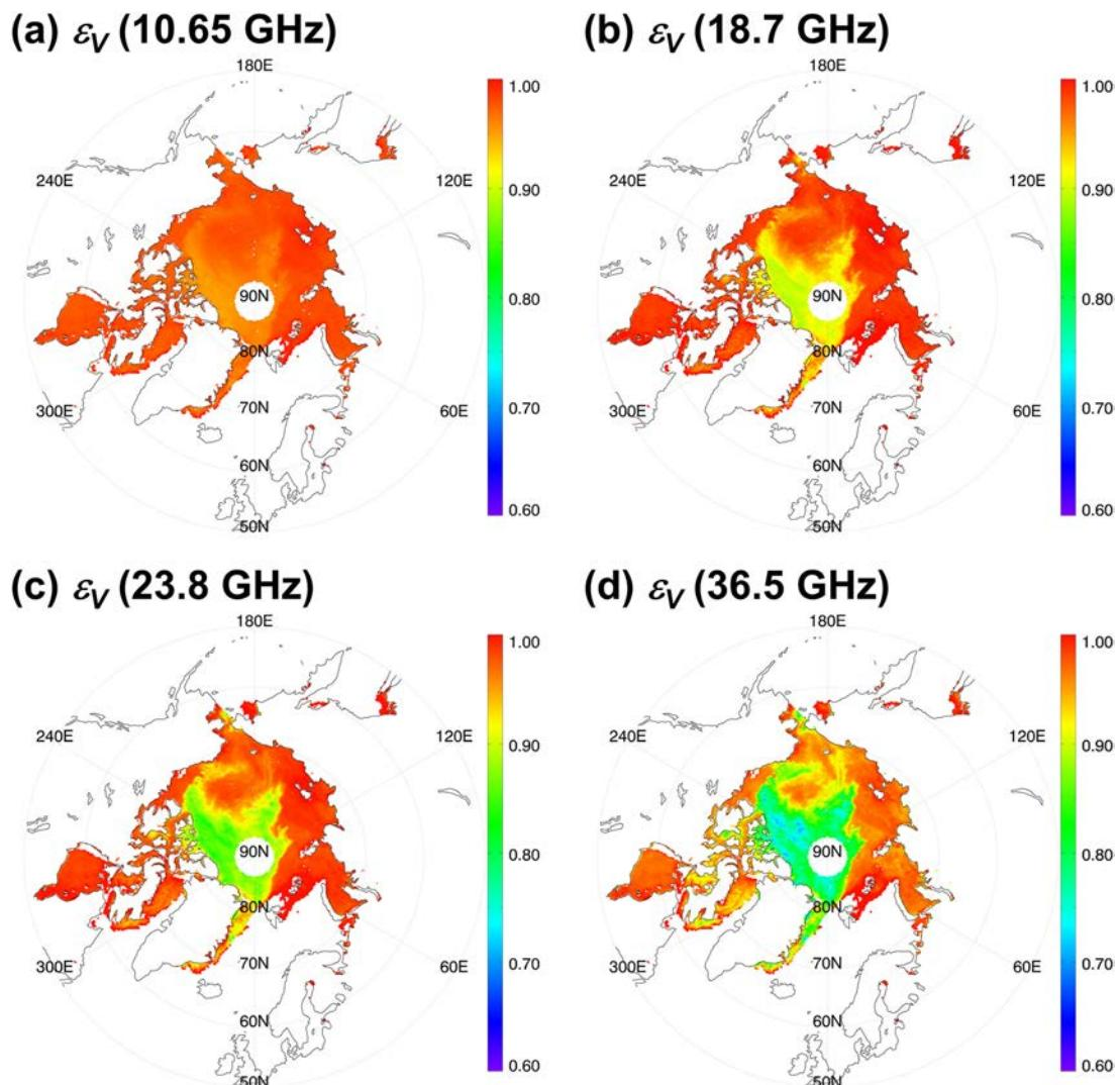
**3.6.15. pav.** 2010 m. sausio 1 d. virš Arkties vandenyno AMSR-E jutiklio užfiksuota spinduliuavimo geba vertikalioje polarizacijoje ( $\epsilon_V$ ) mikrobangų ruože: a) 10,65 GHz; b) 18,7 GHz; c) 23,8 GHz; d) 36,5 GHz. Sezoninis ledas pasižymi didesne (rausva spalva), o daugiametis – mažesne spinduliuavimo geba (žalia, melsva). Kuo didesnis dažnis, tuo ryškesnė riba tarp skirtingo amžiaus ledo (Lee ir kt., 2017).
