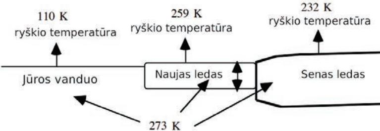
Kūno spinduliavimo geba priklauso nuo dielektrinių kūno savybių (savitojo laidžio, vandens ir druskos kiekio), kūno paviršiaus šiurkštumo, stebėjimo kampo ir spinduliutės poliarizacijos. Mikrobangų diapazone spinduliavimo geba yra atvirkščiai proporcinga santykinei dielektrinei skvarbai, kuri apibūdina kūno galimybes perduoti elektrinį lauką. Santykinę dielektrinę skvarbą ( $\epsilon_r$ ) sudaro reali ( $\epsilon'$ ) ir menama dedamoji ( $\epsilon''$ ):
