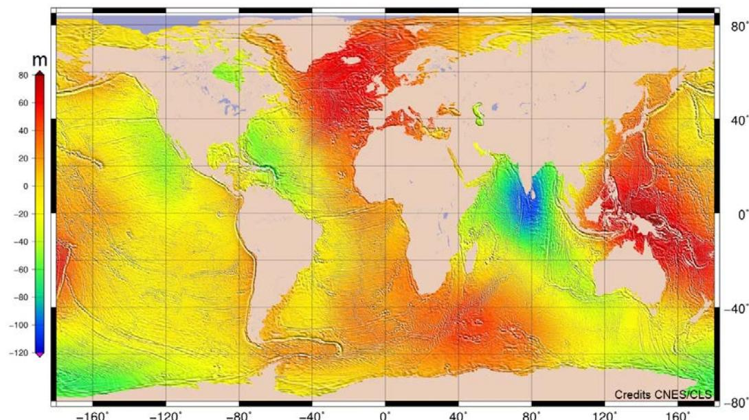
**3.5.8. pav.** Vidutinis 1993–2012 m. vandens lygis virš referencinio elipsoido. Paveikslas sukurtas naudojant CNES/CLS įvairių palydovų misijų radiometrų duomenų asimiliacijos MSS\_CNES\_CLS\_15 produkta (AVISO, 2016).
