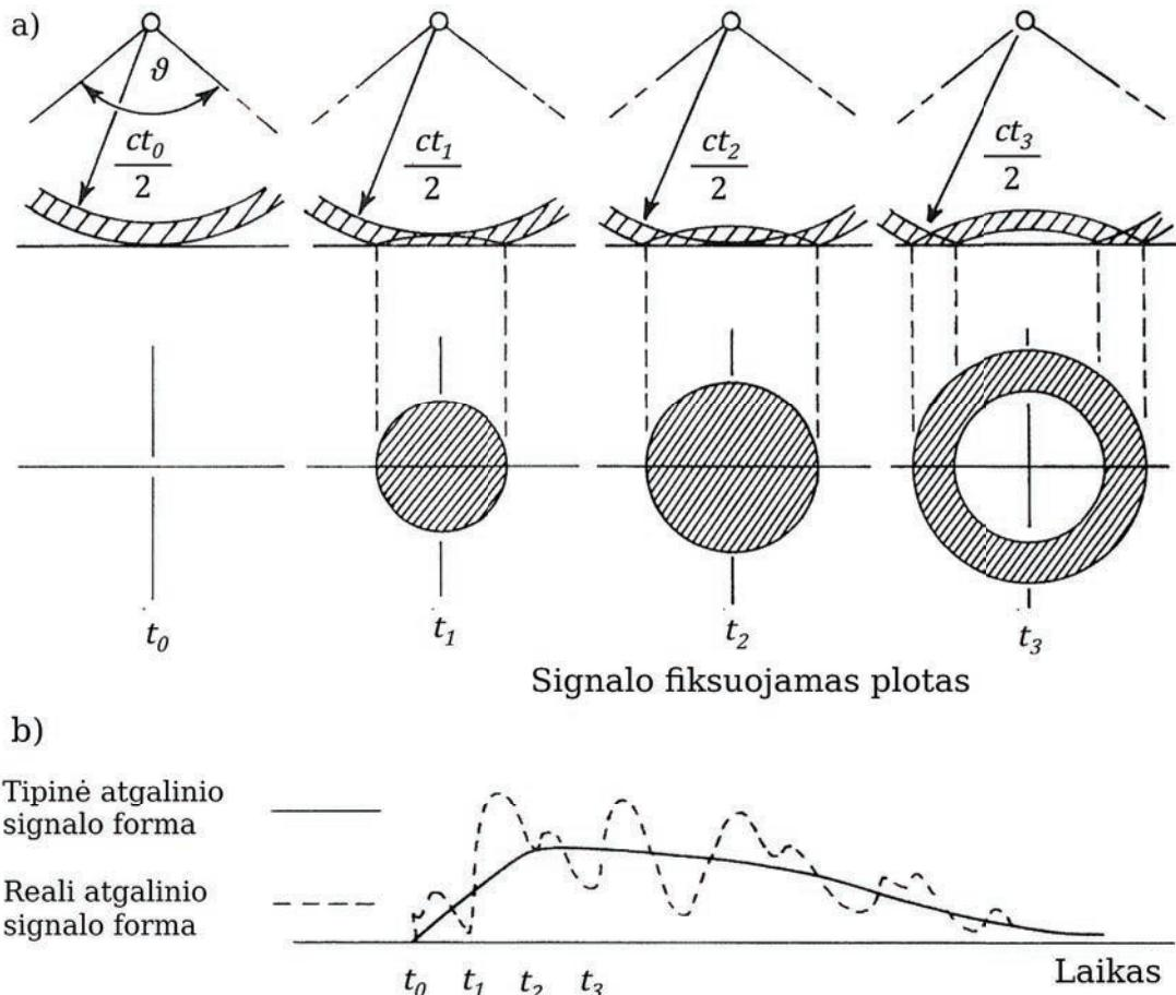
**2.5.17. pav.** Altimetro siunčiamo ir gaunamo signalo schema: a) siunčiamuojo  $\vartheta$  pločio signalo fiksuojamas plotas skirtingu laiko momentu  $t_0-t_3$ ,  $c$  – šviesos greitis, pilki apskritimai žymi, iš kokio paviršiaus ploto gaunamas atgalinis signalas; b) į anteną grįžtančio atspindžio bangos forma  $t_0-t_3$ , laiko momentais (pagal Rapley ir kt., 1983).
