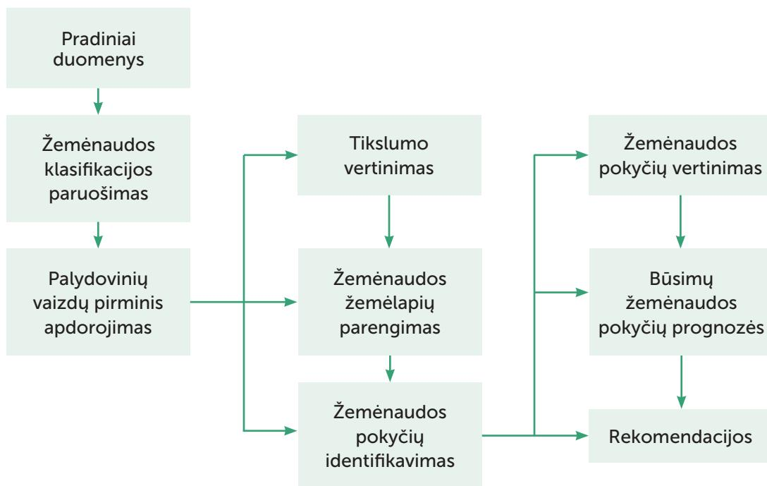
**3.1.1. pav.** Žemės naudojimo kaitos identifikavimo principinė schema.
