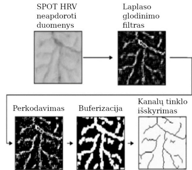
**2.2.14. pav.** Jutiklių SPOT HRV, HRVIR ir VEGETATION charakteristikos ir kanalų tinklo išskyrimo procedūros iš SPOT HRV panchromatininių duomenų (pagal Svoray, 2004).
