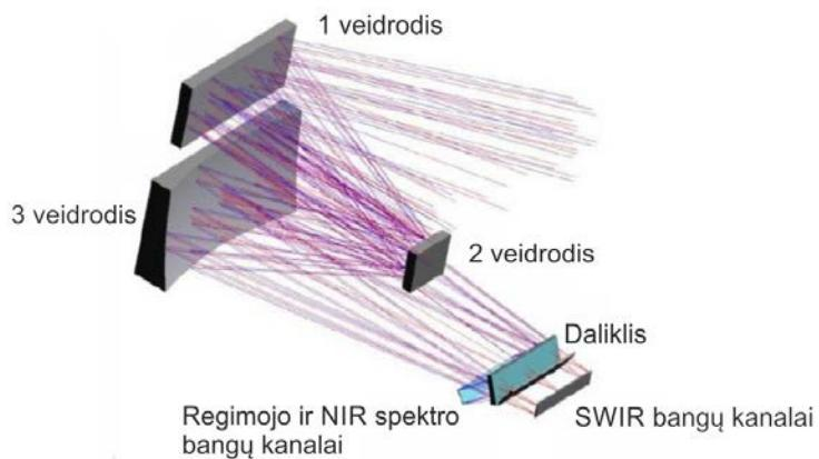
Palydovų *Sentinel 2* jutiklis turi 13 spektro kanalų (palyginimui – palydovas *Landsat 8* turi 11). Erdvinė palydovo vaizdų skiriamoji geba variuoja tarp 10, 20 ir 60 m skirtinguose kanaluose. Spektrinė skiriamoji geba taip pat skiriasi, 18 nm ji siekia 740,2 nm bangų ilgio ruože ir net 238 nm – 2204,4 nm ruožo kanale. Palydovo erdinė paviršiaus aprėptis – 290 km (detalus aprašymas pateiktas 2.2.3. lentelėje, žr. 2.2.2. skyrelj).
