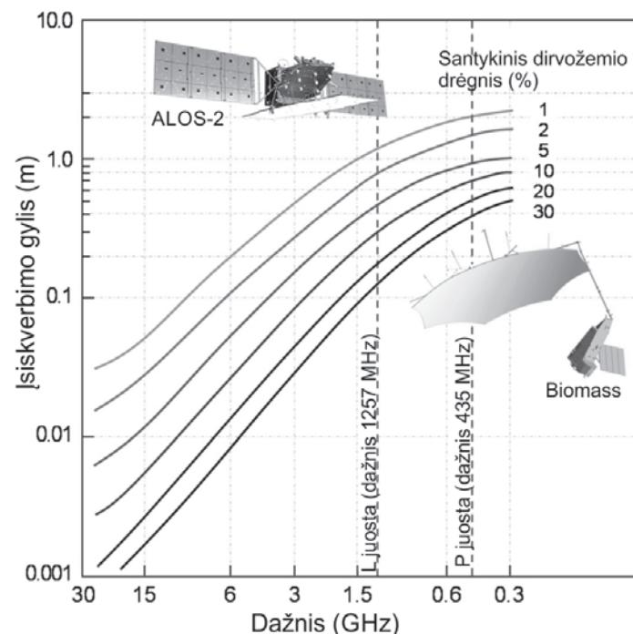
**3.2.9. pav.** SAR spinduliuotės skvarbos į dirvožemio viršutinį horizontą funkcija priklausomai nuo spinduliuotės dažnio (Koyama ir kt., 2017).
