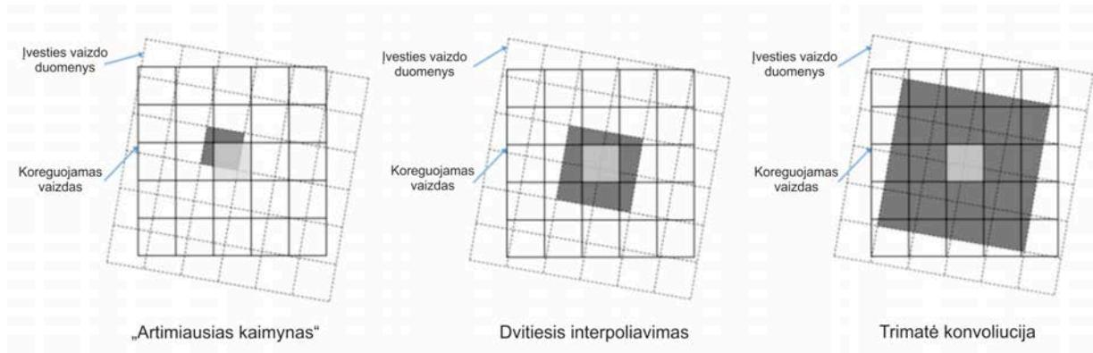
**2.6.3. pav.** Vaizdo pikselių pertvarkymo metodų principinė veikimo schema
