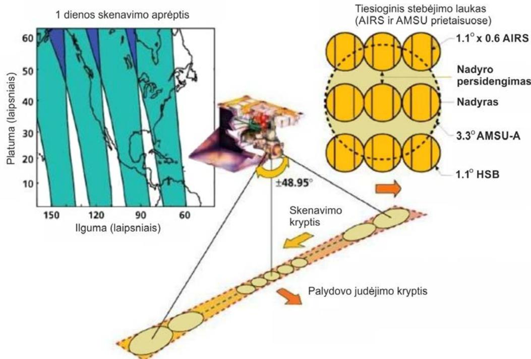
**2.3.11. pav.** Infraraudonojo spektro vertikalaus zondavimo jutiklio skersai nadyro taško skenavimo principas ir paviršiaus erdvinė apréptis skenavimo metu (AIRS jutiklio pavyzdžiu) (pagal Nacionalinę vandenynų ir atmosferos administraciją, palydovų taikymo ir tyrimų centrą (NOAA STAR), 2016).
