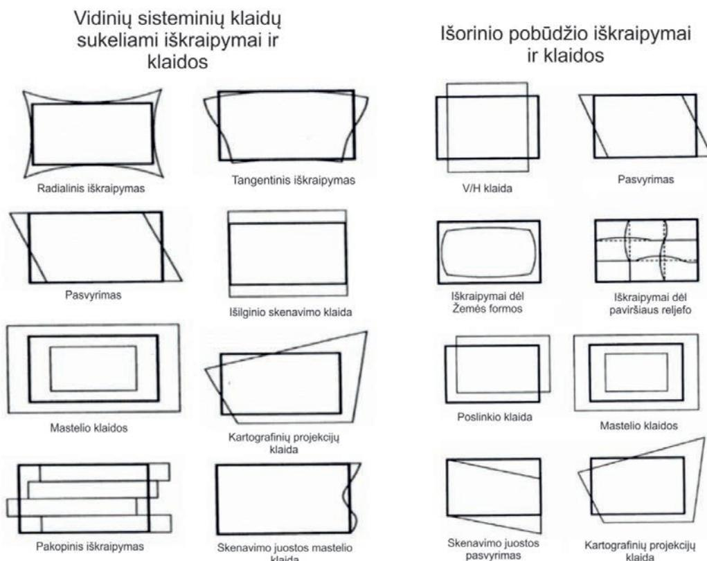
**2.6.1. pav.** Vidinių sisteminių ir išorinių geometrinių vaizdo duomenų iškraipymų pobūdis (pagal Dave ir kt., 2015).
