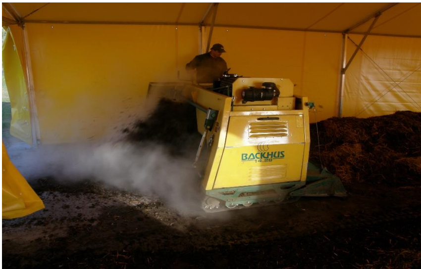
2 pav. Kompostuojamos atliekos maišomos specialiu įrenginiu, pakankamam deguonies kiekiui kaube užtikrinti.
